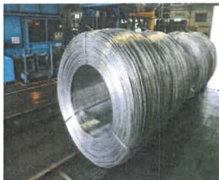
เส้นลวดอลูมิเนียมขนาดเส้นผ่าน ศูนย์กลาง 9.5-25 มิลลิเมตร (Aluminium Wire Rod)
